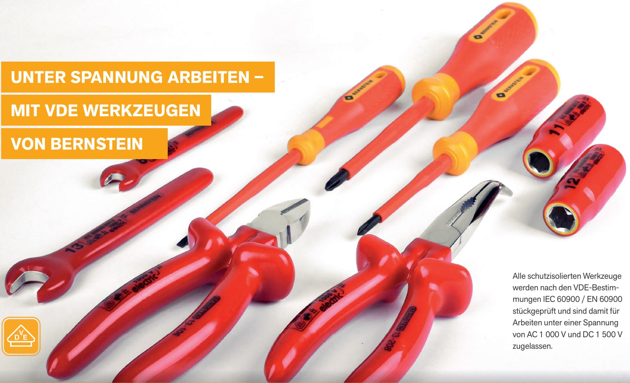
Alle schutzisolierten Werkzeuge werden nach den VDE-Bestimmungen IEC 60900 / EN 60900 stückgeprüft und sind damit für Arbeiten unter einer Spannung von AC 1 000 V und DC 1 500 V zugelassen.
